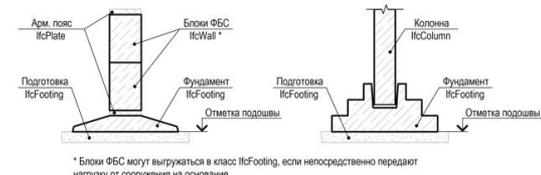
\* Блоки ФБС могут вытиснуться в класс ИсFooting, если непосредственно передают нагрузку от сооружения на основание
